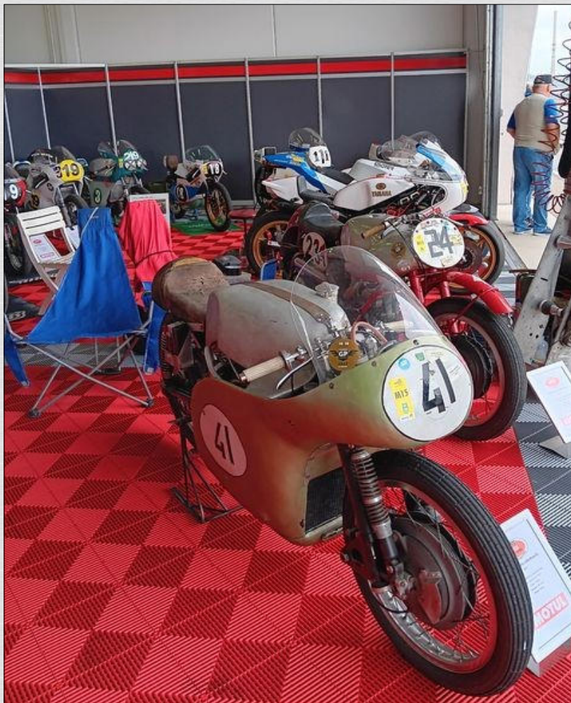
Foto oben: Hohe Ingenieurkunst aus der damaligen Tschechoslowakei. Die CZ mit dem aufwendig gebauten Vierzylinder Viertakt V-Motor hat Seltenheitswert und war nur kurze Zeit auf den Rennstrecken zu sehen.
