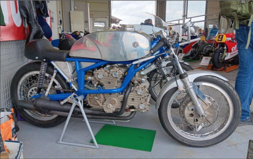
Foto oben: Hohe Ingenieurkunst aus der damaligen Tschechoslowakei. Die CZ mit dem aufwendig gebauten Vierzylinder Viertakt V-Motor hat Seltenheitswert und war nur kurze Zeit auf den Rennstrecken zu sehen.
